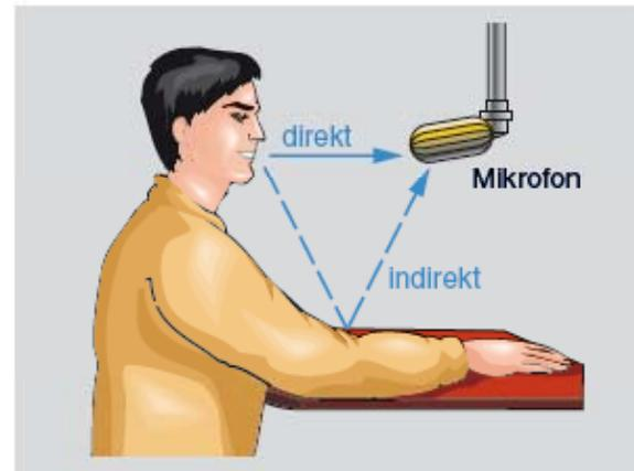
Klangfärbung durch Überlagerung von direktem Schall und Reflexionen beim Mikrofon
