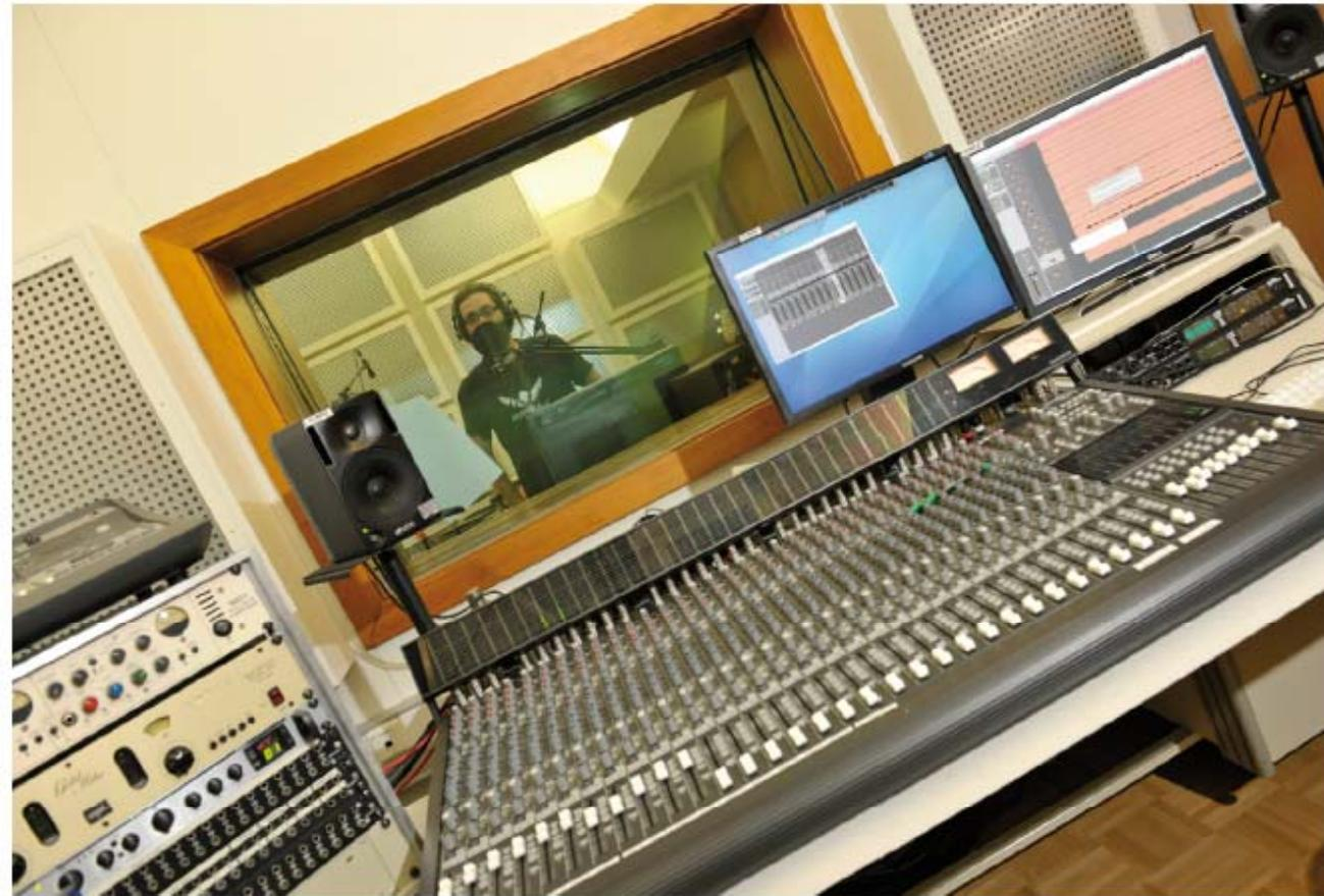
Tonstudio: Sprecherkabine, Lautsprechermonitore, PC mit Aufnahme- und Bearbeitungssoftware, Gegensprechanlage, analoges Mischpult, Peripheriegeräte im 19"- und 9,5"-Einbaumaß, MIDI-Masterkeyboard
